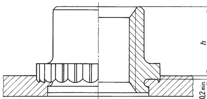
Bild 2. Einpreßmutter eingebaut
